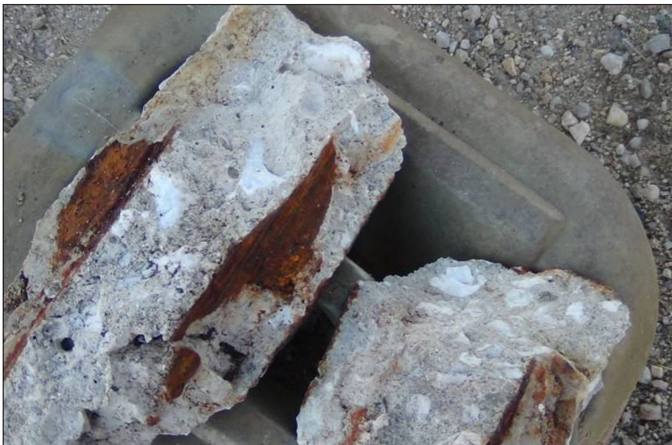
Φώτο 9: Τμήματα αποκολλημένης επικάλυψης λόγω οξειδωμένου οπλισμού και εκτίναξης.
