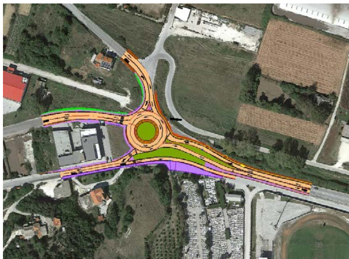
Εικόνα 1 Έργο διαμόρφωσης ισόπεδου κυκλικού κόμβου, ως κόμβος εισόδου-εξόδου της Ελευθερούπολης Καβάλας στη συμβολή των οδών Παπαρησιτίδη-Μητροπολίτη Αμβροσίου-Λεωφόρου Σερρών. Παρουσιάζεται η οριζοντιογραφία του έργου επί της ορθοφωτογραφίας του Ελληνικό Κτηματολόγιο.(άνευ κλίμακας).
