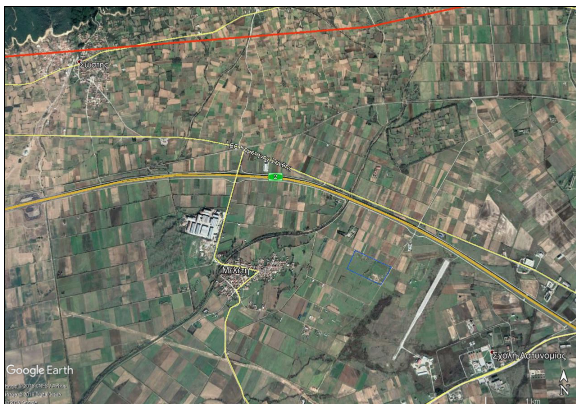
Σχήμα 3.1. Δορυφορική εικόνα της ευρύτερης περιοχής του Δικτυακού Τόπου (μπλε γραμμή) με την υπάρχουσα κύρια ζώνη ρηγμάτων της Καβάλας-Ξάνθης-Κομοτηνής (κόκκινη γραμμή) βάσει της βάσης δεδομένων των ενεργών ρηγμάτων του Εθνικού Αστεροσκοπείου Αθηνών.
